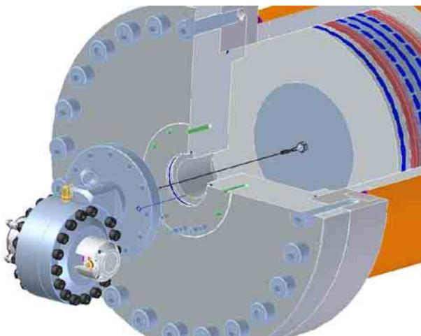
Переместите датчик к крышке цилиндра и вставьте резьбовые шпильки в отверстия фланца.
