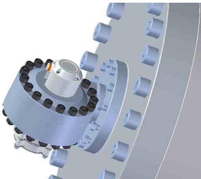
Крепко затяните гайки на резьбовых шпильках на донной поверхности датчика. Затяните болты и гайки крест-накрест указанным моментом. Если не указано иначе в руководстве по цилиндру, примените следующие моменты:
