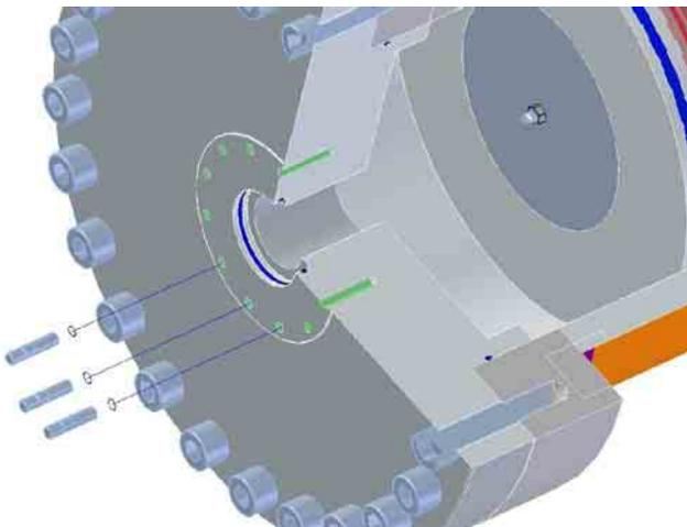
Ввинтите 3 резьбовые шпильки в крышку цилиндра.
