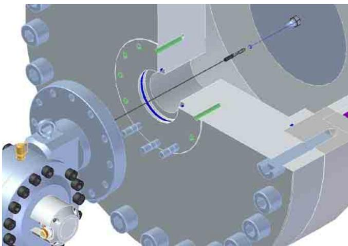
Переместите датчик ближе к отверстию крышки цилиндра (воспользуйтесь подъёмным устройством, например, краном). Удалите защитную крышку с выхода троса. Откройте карабин и пропустите трос через отверстие. Зацепите карабин за проушину шпильки-фиксатора и закройте блокировочную застёжку.
