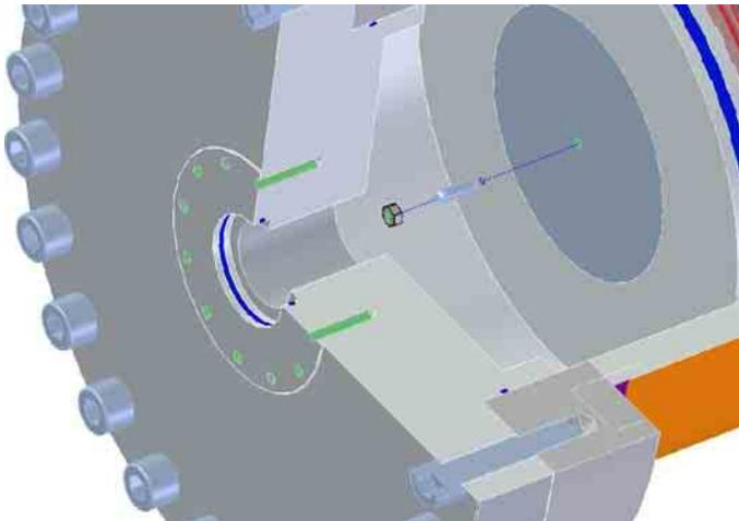
Установка фиксатора троса осуществляется ввинчиванием шпильки с проушиной в шток цилиндра и закончиванием с помощью контргайки.
