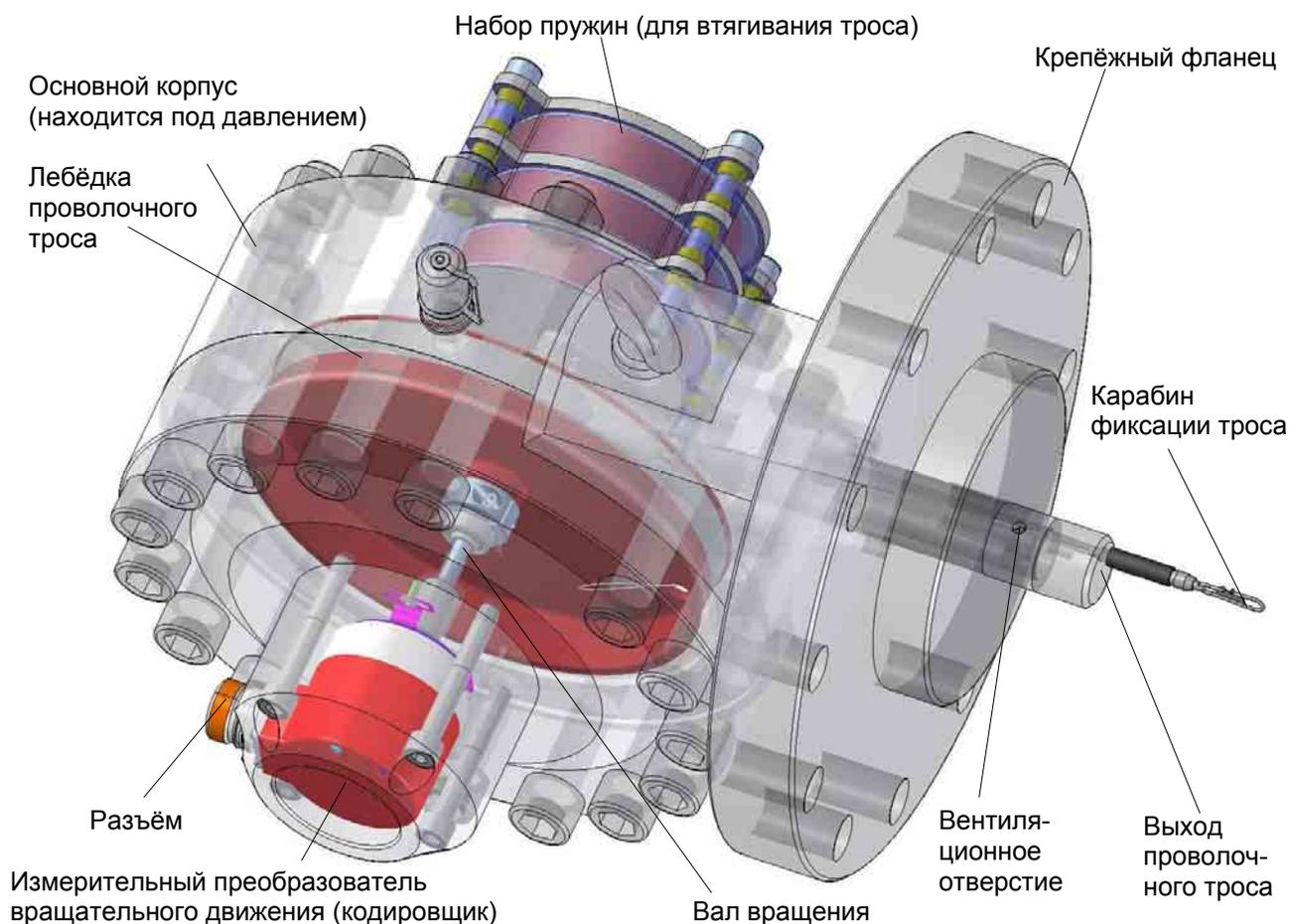
С помощью постоянного подпружиненного усилия измерительный трос наматывается точно и послойно на лебёдку проволочного троса, таким образом, линейное движение преобразуется во вращательное. Измерительный преобразователь вращательного движения обеспечивает требуемый выходной сигнал. Динамика вытяжного тросового датчика позволяет достичь высокой скорости движения и максимального ускорения поршня цилиндра. Высокое качество датчика допускает его эксплуатацию в суровых производственных средах.
